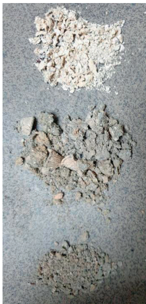
Rys.1. Widok popiołów po spaleniu brykietu i węgla kawałkowego (od góry: brykiet z katalizatorem; brykiet z sorbentem; węgiel kawałkowy – materiał własny).
