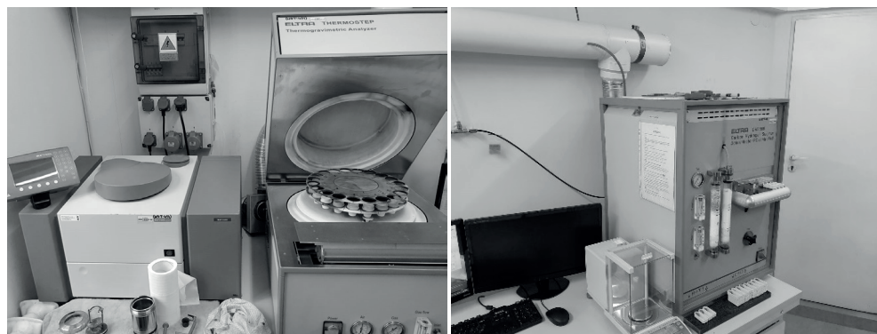
Rys.1. Stanowiska laboratoryjne wykorzystane do wykonania analizy technicznej i elementarnej badanych paliw
